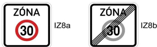
Obrázek 64 – Svislé dopravní značení zóny 30
