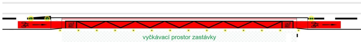
Obrázek 51 – Zastávka se zvýšeným cyklistickým pásem v rámci vyhrazeného jízdního pruhu pro cyklisty
