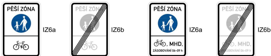
Obrázek 62 – Svislé dopravní značení pěší zóny s povoleným vjezdem cyklistů
